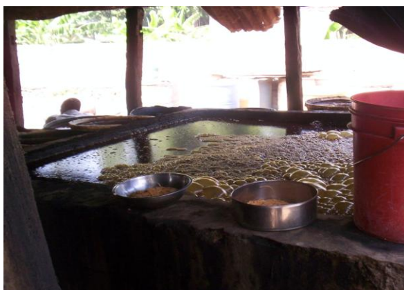
Photo 4 : Bassin de fermentation en béton à Gros Morne
