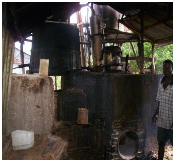
Photo 1 : Château d'eau, alambic et foyer dans une distillerie à Gros Morne
